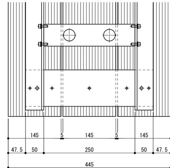
※ 製品は擁壁コンクリートのサイズに合わせてサイズ変更(W/D)が可能です。
