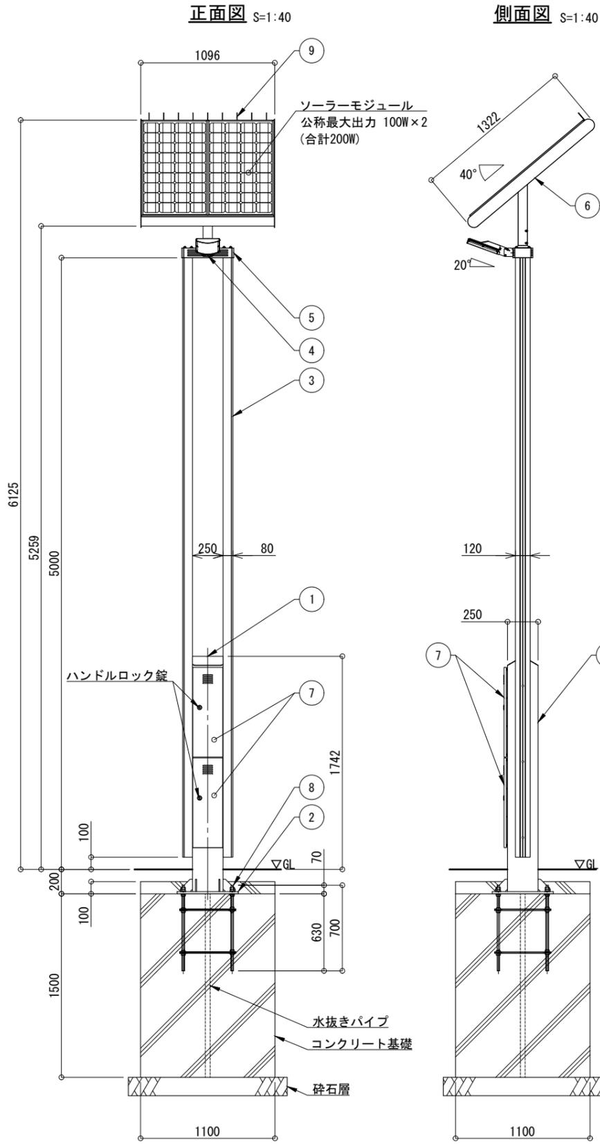
※基礎寸法は耐風速60m/s(設計例)
