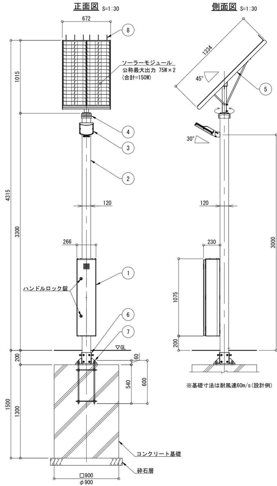
※基礎寸法は耐風速60m/s(設計例)
