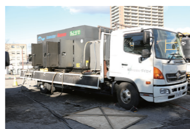
超高压水生成ポンプ車 洗浄後の汚れを強力に吸引する真空バキューム車
