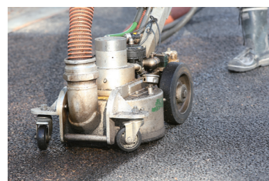
SJ-V 洗浄ユニット エアモーターによる回転洗浄で均一な施工を実現
