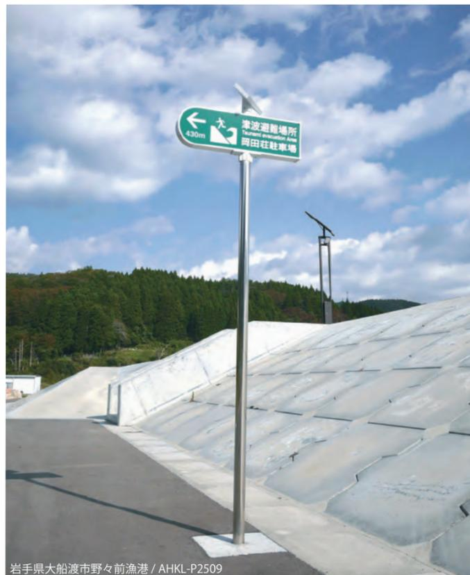
サインの形状が避難する方角を著している誘導サインです。ソーラーパネルを搭載し、夜間にLEDを点灯させます。独立電源のため、電気引き込み工事不要で停電時でも点灯します。
