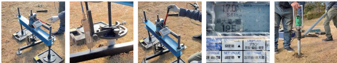
3. 螺杭に引抜試験機装着 4. 変位計装着 5. 指定数値まで引き抜き 6. 測定値 7. 逆回転により螺杭引き抜き
