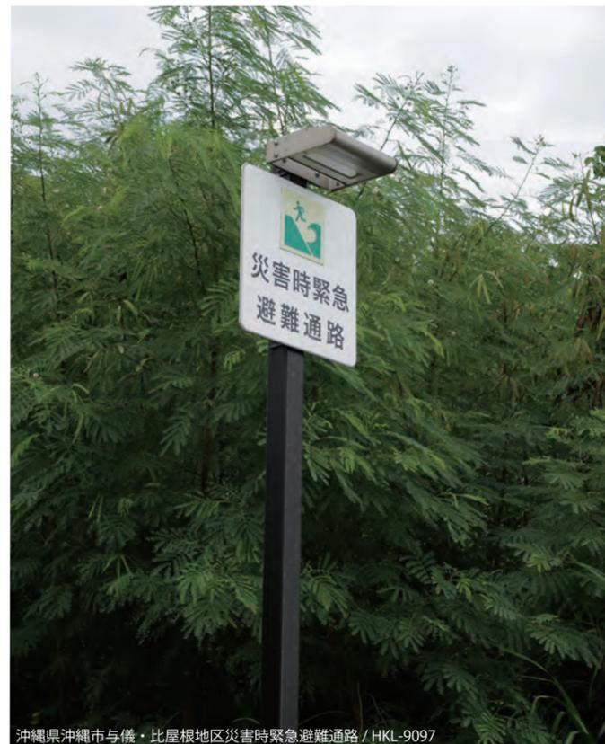
JISの定めた津波避難誘導標識システムに準じた、蓄光板とソーラー照明を合わせたハイブリッド型の標識です。
