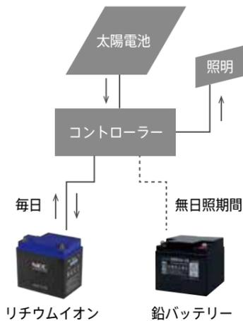
リチウム鉛ハイブリッドシステム系統図
